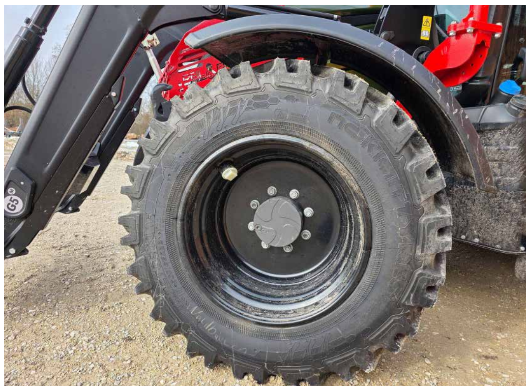
Forstspezialbereifung mit verstärkter Felge und Ventilschutz sowie abnehmbarem Kotflügel.
