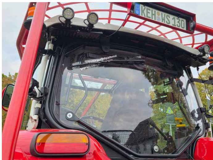
Fahrerschutz ohne Sichteinschränkung: Scheibe aus Polycarbonat.
