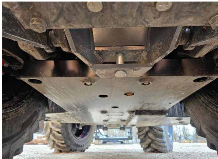
Von unten „gepanzert“: Unterfahrschutz mit Wartungsöffnungen.
