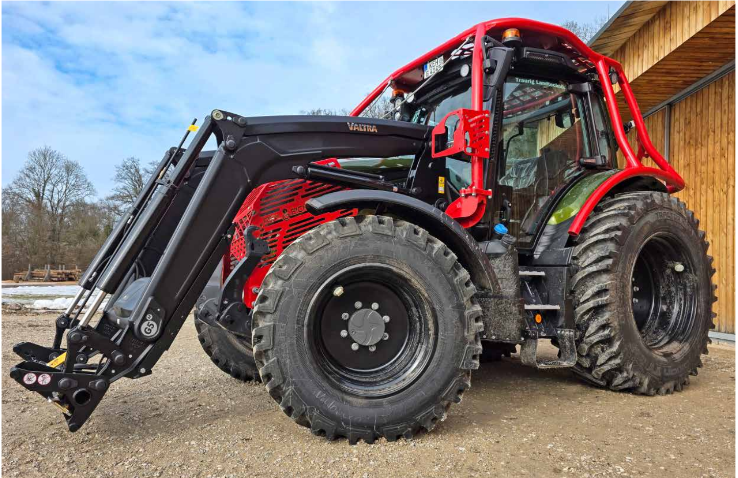
Einer der beiden neuen Forstschepper an der Waldbauernschule: Valtra N155 mit zertifizierter Forstausrüstung von pro Jernac
